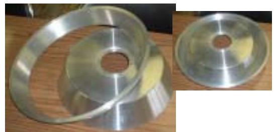
高精度な加工(合わせた時のスキマがゼロ)
